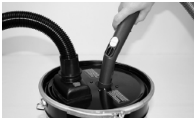
Centralstøvsugerens slangehåndtag stikkes gennem gummipakningen på låget.
